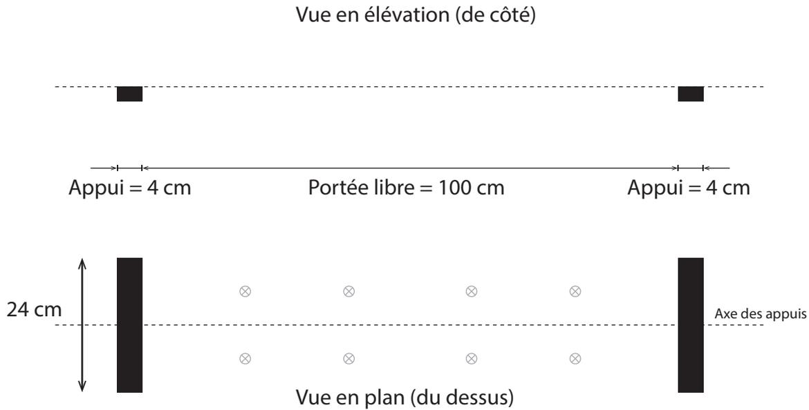
Figure 1 : Vue en plan et en élévation des appuis.
